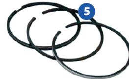
Pístní kroužky (5) jsou označeny logem AGS Premium quality na horní straně kroužku vedle zámku a touto značkou je třeba je montovat směrem nahoru. Zámky pístních kroužků je třeba při montáži pootočit proti sobě.
