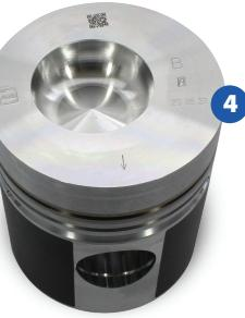
Píst je na dně označen logem AGS Premium quality, datem výroby, třídícím rozměrem a šipkou označující směr montáže. (4) Při montáži je bezpodmínečně nutné dodržet stejný třídící rozměr válce a pístu. Šipka musí směřovat směrem k rozvodům.
